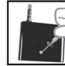
2) Remplacer la pile usage CR1632 par une nouvelle pile et vérifier que le pôle positif (+) de la pile soit bien positionné vers le haut.
